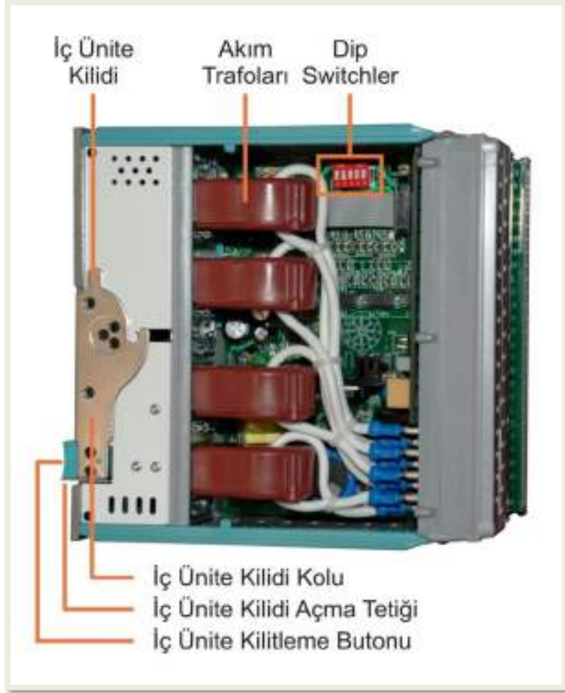
CPM 310 G: İç Ünite, Sağ yan görünüm
